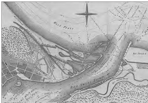
Ryc. 3. Początkowa faza rozbudowy świnoujskiego portu w połowie XIX w. Widoczny system basenów i ostróg przyspieszających osadzanie piasku wzdłuż falochronu zachodniego
